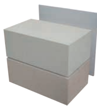
壁:レンガ180mm+シリカボード6mm
