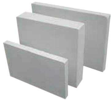
壁:セラミックボード25mm+50mm+65mm 内張りには1600℃用を使い、収縮0%
