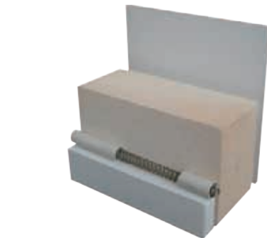
壁:セラミックボード25mm+レンガ120mm+シリカボード6mm
