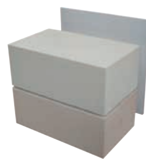
壁:レンガ180mm+シリカボード6mm
